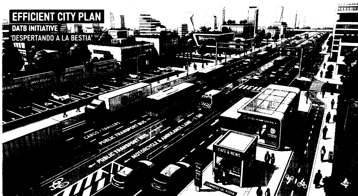
FIGURA 1: Modelo conceptual de 'Calle de Alto Rendimiento'. Reingeniería de flujo vial, segregación de transporte pesado, infraestructura digna para el usuario y ordenamiento del espacio público mediante la delimitación de frentes privados.
